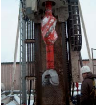
Rollenmeißel für Geothermiebohrung
